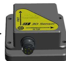
Le logiciel SBG Center enregistre des points de calibration magnétiques. Il est possible d'utiliser plusieurs fichiers de points de calibration magnétique pour une seule et même calibration trois dimensions. Ce qui permet de séquencer la procédure de calibration sur plusieurs étapes.
