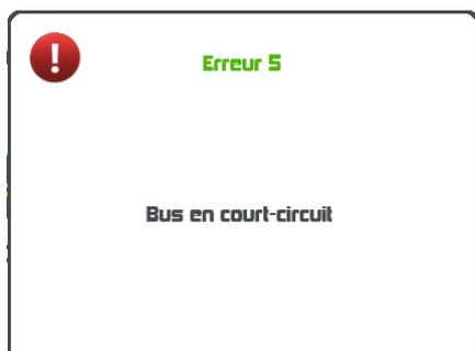
Le fil noir du bus Topline sur lequel transitent les données est en court-circuit avec un des 2 autres fils. Ce court-circuit peut être localisé dans un câble, une boîte de connexion ou un des éléments branchés sur le bus.
