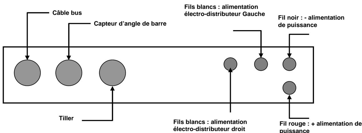
Le *calculateur GYROPILOT 2 CRP* est prévu pour commander les électro-distributeurs d'un groupe électro-pompe hydraulique à débit fixe, généralement monté sur les gros bateaux de plaisance, de pêche et de servitude.
