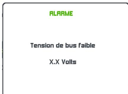
Ce message s'affiche lorsque la tension d'alimentation du bus Topline est inférieure à 9 volts. Les données sont sauvegardées et l'installation s'arrête de fonctionner. Vérifier votre tension batterie et éventuellement la recharger.
