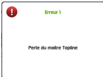
L'afficheur « Maître » qui gère tout le système Topline est débranché du bus ou il ne fonctionne plus. Dépannage possible en remplaçant l'afficheur « Maître » par un autre afficheur (voir § « [Adresse Topline](#) »).
