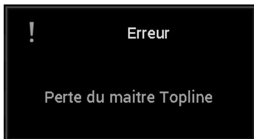
L'afficheur « Maître » qui gère tout le système Topline est débranché du bus ou il ne fonctionne plus. Dépannage possible en remplaçant l'afficheur « Maître » par un autre afficheur (voir § « Adresse Topline »).
