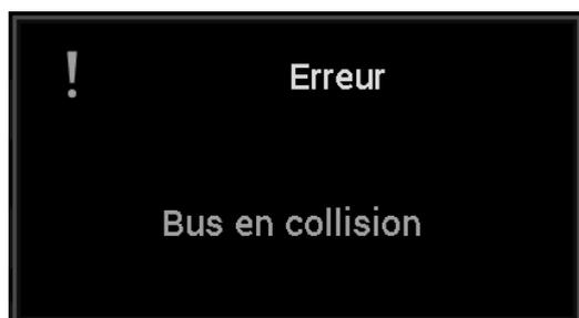
2 capteurs de même type sont branchés sur le bus et envoient les mêmes données, ou une interface « Entrée NMEA » a été initialisée avec les mêmes données qu'un capteur branché sur le bus. Vérifier les capteurs branchés et réinitialiser les interfaces « Entrée NMEA ».
