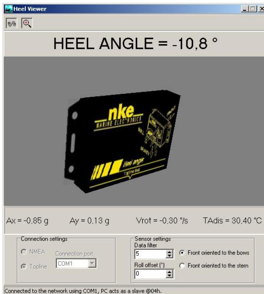
Après avoir choisi le type de connexion (Topline ou NMEA) et le port associé, cliquer sur le bouton « Connect » pour activer l'acquisition des mesures.
