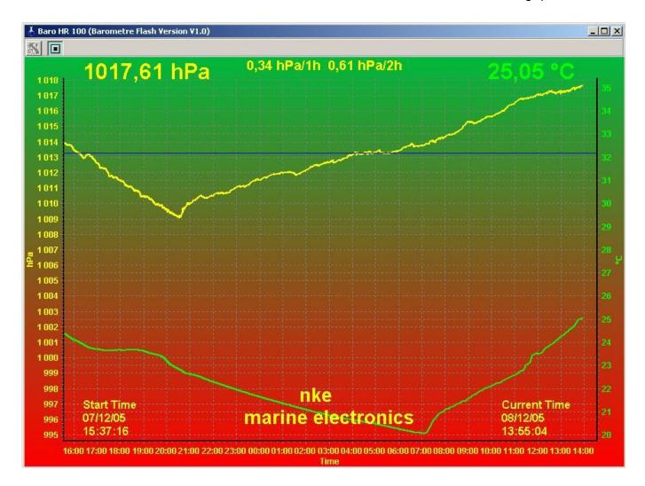
Il est possible d'enregistrer dans un fichier texte les mesures suivants 4 cadences d'enregistrement différentes. Cette cadence d'enregistrement ainsi que la sélection du port COM utilisé sont réglables dans la fenêtre Settings (voir ci contre).
